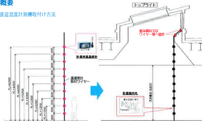
垂直温度計測機の取付け方法
